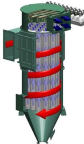
图 8.2-3 斐控圆形布袋除尘器结构图
